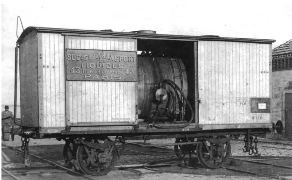
Le N 110 version sans guérite. La porte ouverte montre le détail de la citerne et de la pompe. Collection René Huck.
